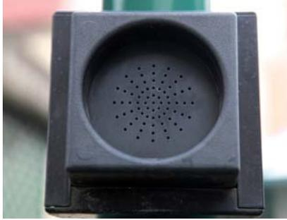
**AFIN DE FACILITER** le déplacement des personnes malvoyantes ou non voyantes, la Communauté d'agglomération de la Vallée de la Marne équipe progressivement les feux tricolores d'un dispositif sonore déclenché par une télécommande individuelle à fréquence radio. L'ensemble des carrefours à feux tricolores de la ville sera sonorisé d'ici la fin de l'année.
